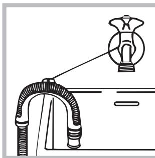
ou bien accrochez-le à un évier ou à une baignoire, dans ce cas, fixez le support en plastique fourni avec l'appareil au robinet (voir figure). L'extrémité libre du tuyau d'évacuation ne doit pas être plongée dans l'eau.
